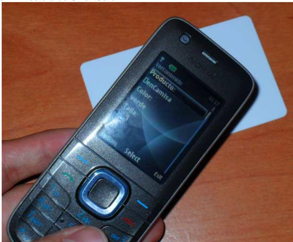
De esta forma se realizó la prueba y despliegue del prototipo, logrando pasar información determinada desde una interfaz Mifare a un teléfono móvil a través de tecnología NFC.
