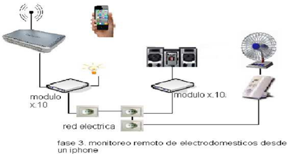
Figura 11: Diseño de la red X.10 fase 3.
