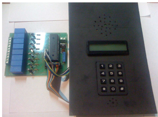
Figura1. Prototipo citofonía con teclado tipo teléfono
