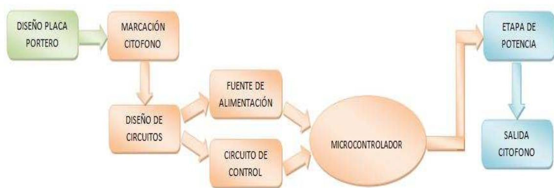
Figura 15. Diagrama del sistema de citofonía
