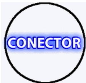
Este es utilizado para enlazar dos partes cualesquiera de un diagrama a través de un conector de salida y un conector de entrada. Esta forma un enlace en la misma página del diagrama.
