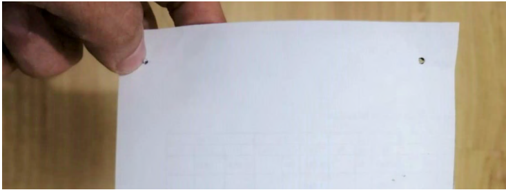
Imagen 32. Operación 3: marcado y perforación de agujeros.
