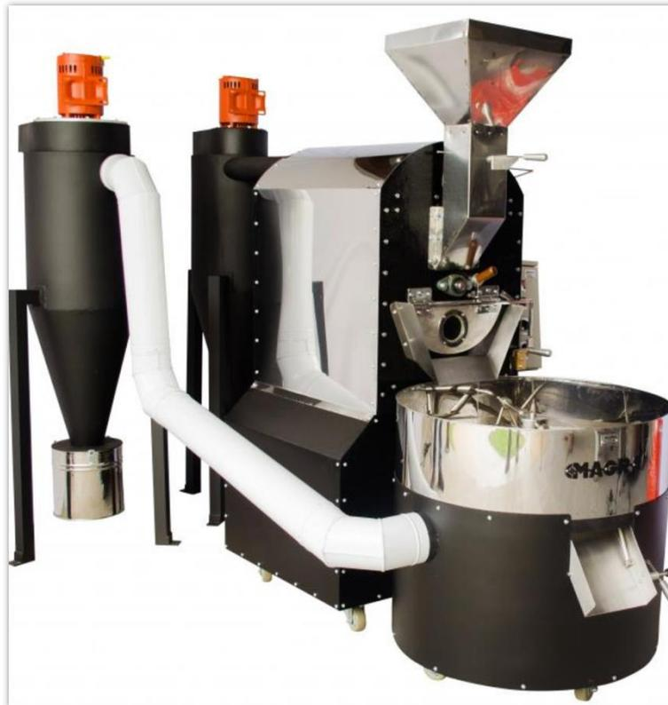
**Figura 3:** Tostadora de café. Adaptado de: “Tostadoras para café” por Magra, 2023.
