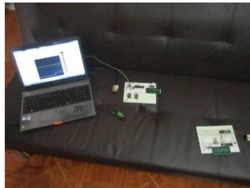
El accionamiento de las alarmas se hace entonces, como se menciona anteriormente, con la conexión de 2 relés, uno para accionar la alerta amarilla que se da cuando se transmite el dato 6; o sea, que la lectura del sensor es de 2.5 V y el otro que se acciona cuando el dato 10 es transmitido y la lectura del sensor es de 4.5V.
