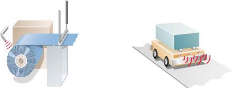
Figura 19.1 Aplicaciones con el sensor ultrasónico DCU 7110
