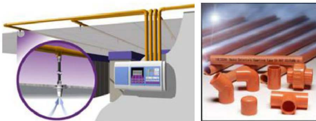
Figura No.21 tubería de Extinción
