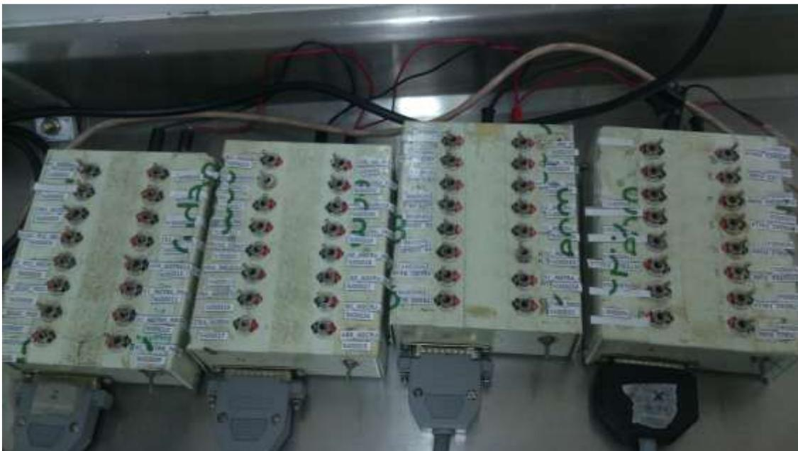
Ilustración 22 : Codillos para simular entradas digitales al PLC
