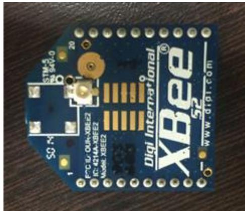
*Figura 2.* Xbee con u.FL Antena. Fuente: Elaboración Propia
