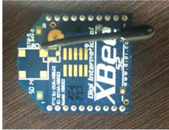
*Figura 1.* Xbee con Wire Antena (Whip Antena). Fuente: Elaboración Propia
