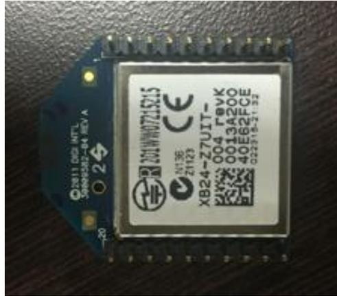
Figura 3. Parte Posterior del Xbee. Fuente: Elaboración Propia
