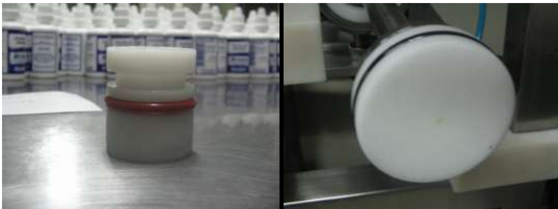
Figura. 18 Tapones de retención de líquido, estos dos tapones se utiliza de acuerdo a la viscosidad de la materia prima a envasar
