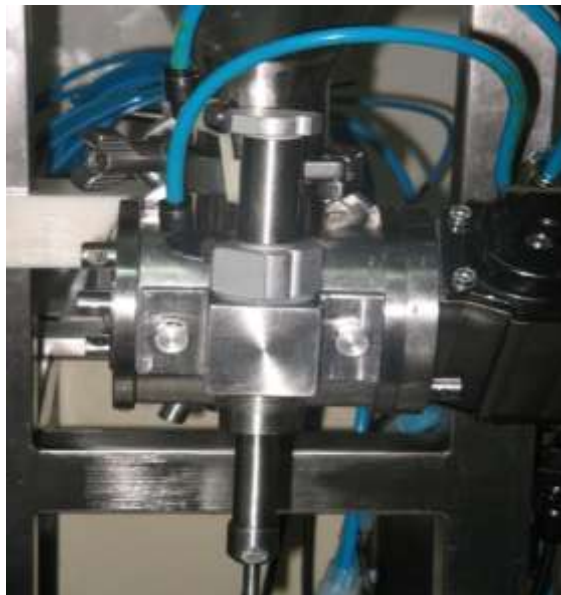
Figura. 13 Inyectora de líquido, en esta se introduce la boca del frasco para realizar el proceso de llenado
