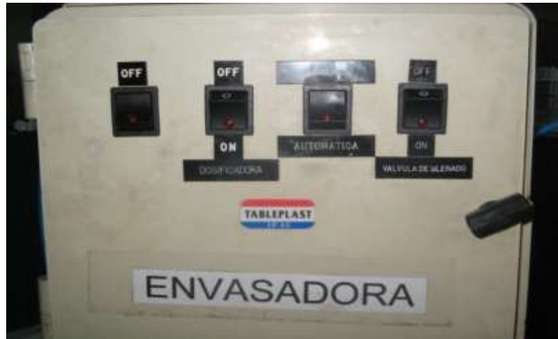
Figura.8 Controles de donde se enciende y programa la llenadora manual mente
