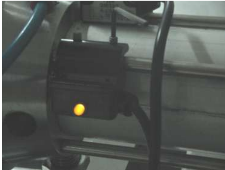
Figura. 16 émbolo del pistón neumático, encargado de subcionar la materia prima
