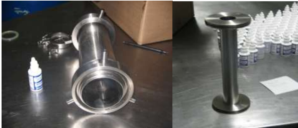
Figura.17 Cilindros de retención de líquido, en el cual se almacena temporalmente la materia prima para luego ser espulsada.
